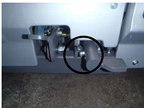
切り替えペダル (FRPカバーは外さず作業できます)
