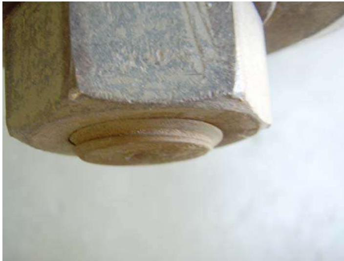
泥や埃がネジ部に堆積している状態。
