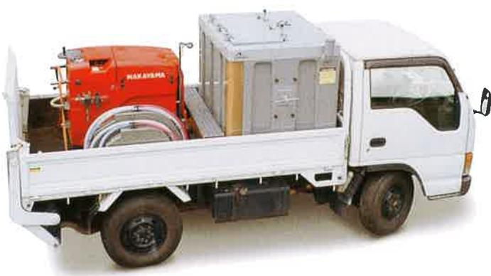
ゼルズは作業効率を犠牲にすることなく泥水処理を完璧に行う環境保全システムです。切削現場では、冷却水の供給と泥水の回収を同時にを行い、持ち帰った泥水は適切に産廃処理を行なってください。
